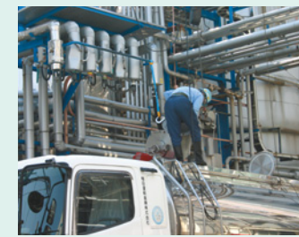
▲タンクローリーの上部で作業をおこなう場合、作業者は腰にロープをつなぐことで、万一の転落事故を防いでいます
